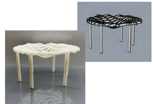
3Dプリンターで作成した模型(左)と、Rhincerosで作成した3Dモデル(右)
